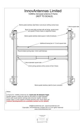
An H frame for 4 x 9el 144MHz LFA Yagis
