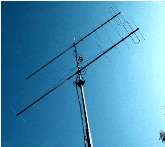
2 x 10el 144MHz LFA Yagis
