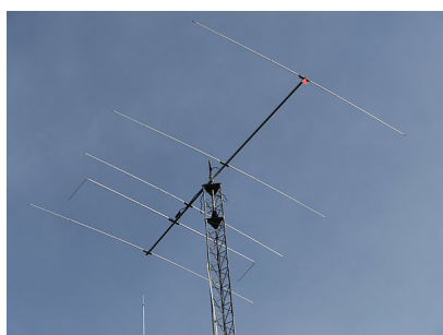
The 26-28Mhz 5el OP-DES at 21AT114
