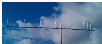
A single 18el (9+9) el X-POL LFA Yagi
